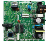
P.C. board for main control (WP-036) มี LED แสดงสถานะการเกิด Error
